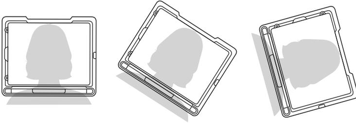
Bringen Sie den TD Pilot an Ihrem Montagesystem oder auf einer stabilen Oberfläche vor dem Benutzer in Augenhöhe oder leicht darunter an. Falls der Kopf nach links oder rechts geneigt ist, neigen Sie den TD Pilot entsprechend. Hierbei ist es wichtig, dass der Winkel der Bildschirmoberfläche dem Winkel des Gesichts des Benutzers angepasst ist. Bei den meisten Benutzern, die an einem Tisch oder Schreibtisch sitzen, muss der TD Pilot höher als die Tischoberfläche positioniert werden.
