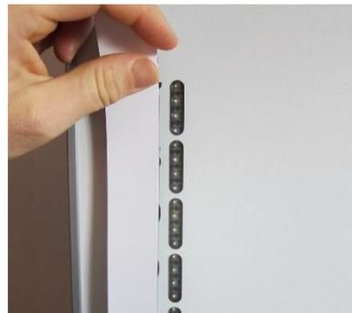
Verwenden Sie einen Magnetstreifen, um die Anzeige der Nachtstunden gleichermaßen zu verdecken.
