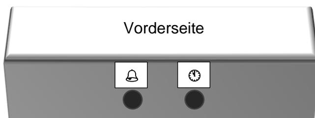
1. Wechseln Sie in den Modus für die Zeiteinstellung, indem Sie die Taste
