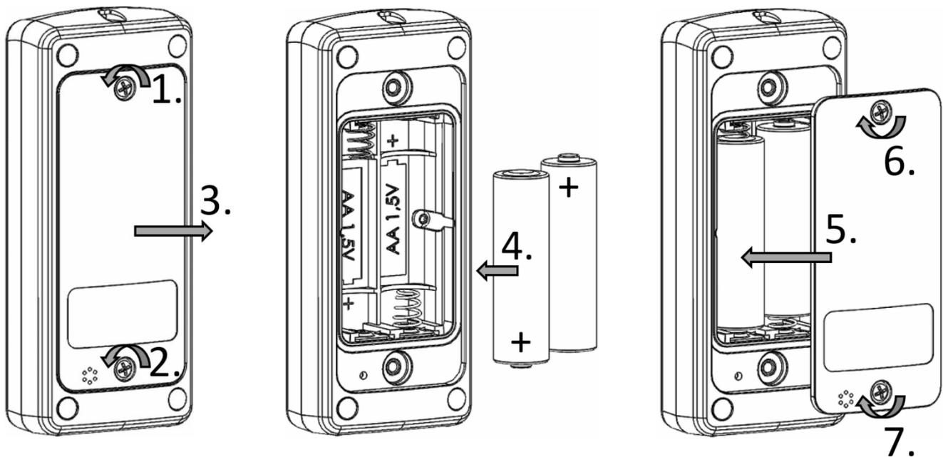
Stellen Sie sicher, dass die Abdichtung der Batteriefachabdeckung keine Schäden oder Abrieb aufweist, bevor Sie diese wieder anbringen.
