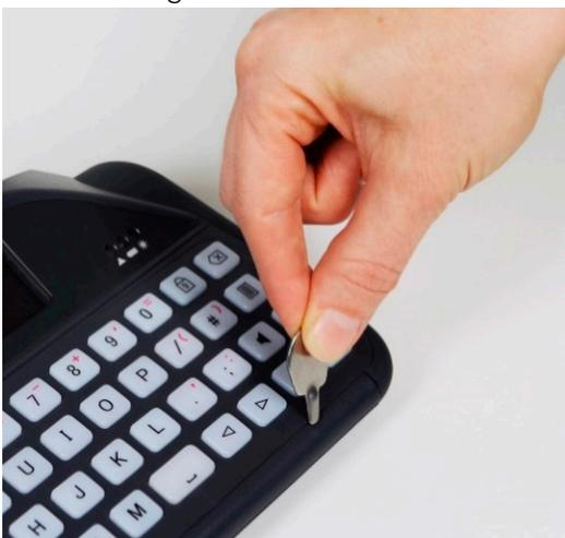
3. Wiederholen Sie Schritt 2 mit dem linken und mittleren Hebelpunkt, bis die Vorderseite der Tastenführung vollständig vom Lightwriter gelöst ist. Wenn sie noch etwas fest sitzt, benutzen Sie das Wechselwerkzeug erneut an jedem der Hebelpunkte.
