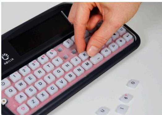
4. Wenn alle Tasten eingesetzt sind, bringen Sie die Tastenführung entsprechend den Schritten 5 bis 7 von **Die Tastenführung austauschen** wieder an. Ihre Tastatur ist jetzt einsatzbereit.
