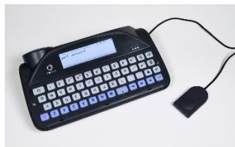
Verbinden Sie einen Schalter mit **Anschluss 1**. Drücken Sie den **Schalter**. Der Scandurchlauf beginnt automatisch.
