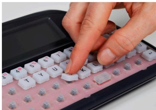
2. Nachdem Sie die Tastenführung entfernt haben, **können** Sie alle Tasten problemlos von der Tastatur nehmen. Passen Sie auf, dass Sie keine Tasten verlieren.
