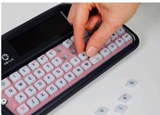
3. Während Tastenführung und Tasten einweichen, reinigen Sie die Gummimatte vorsichtig mit einer feuchten Zahnbürste oder einem feuchten Wattestäbchen. Reiben Sie nicht zu stark auf der Matte, da das Gummi dadurch beschädigt werden können. Achten Sie darauf, alle Feuchtigkeitsrückstände mit einem Tuch aufzunehmen.
