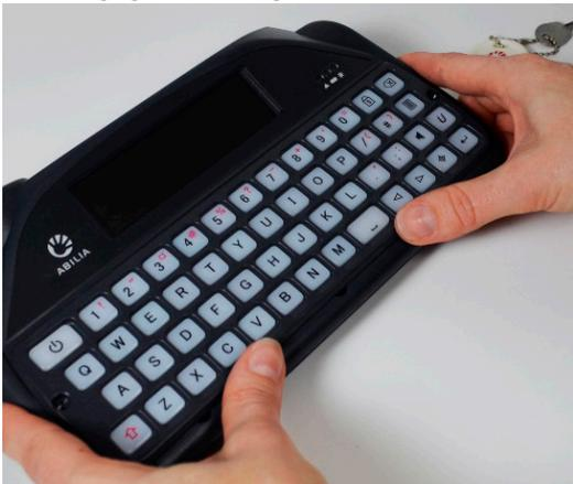
7. Bringen Sie mit dem mitgelieferten Schraubendreher die zwei Schrauben auf den Seiten der Tastatur an. **Drehen Sie die Schrauben nicht zu fest.** Dadurch könnten Sie die Tastenführung oder das Gehäuse Ihres Lightwriter beschädigen. Die neue Tastenführung ist jetzt angebracht.
