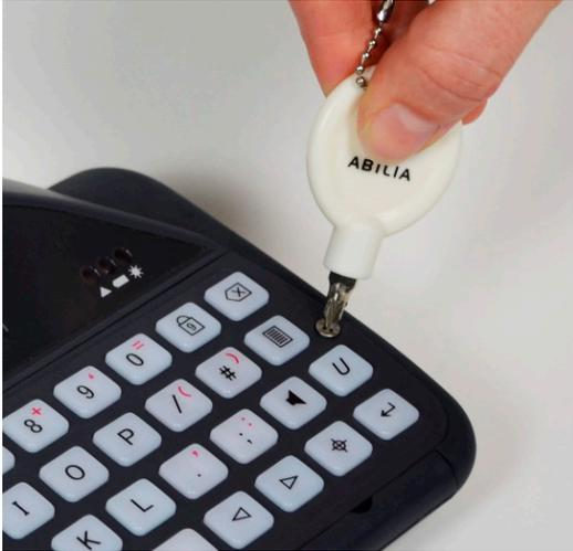
2. Nachdem Sie die Schrauben entfernt haben, setzen Sie das Wechselwerkzeug am rechten Hebelpunkt unten an der Tastenführung an. Die Rundung des Wechselwerkzeugs sollte zu Ihnen zeigen, sodass dieses in die Rundung des Hebelpunktes passt. Drücken Sie das Werkzeug vorsichtig nach unten, um die Tastenführung anzuheben. Sie hören ein leichtes Klicken, wenn sich die Tastenführung löst.
