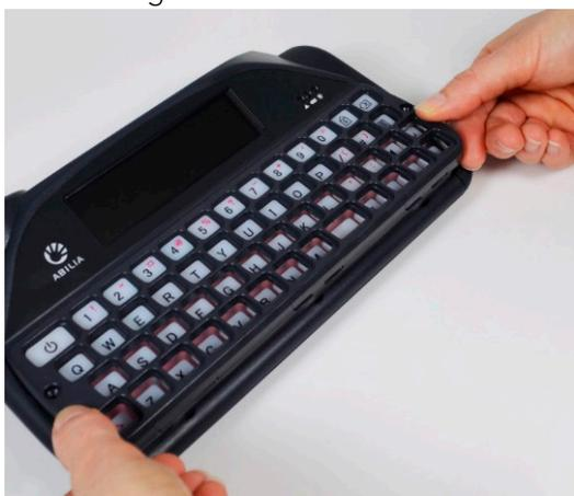
3. Setzen Sie die Tasten entsprechend der neuen Anordnung, die Sie unter **Tastaturlayout** (see previous page) gewählt haben, auf die Gummimatte. Die Tasten müssen gleichmäßig und sicher sitzen. Es kann helfen, die Gummimatte leicht anzufeuchten, wenn Sie die Tasten einsetzen.
