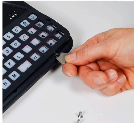
4. Ist die Tastenführung gelöst, greifen Sie diese vorsichtig an der Unterkante und ziehen sie nach oben und nach vorn von Ihrem Lightwriter weg. Sollte sich beim Entfernen der Tastenführung Tasten lösen, drücken Sie diese einfach wieder auf ihren Platz auf der Gummimatte. Achten Sie auf ihren sicheren Sitz.
