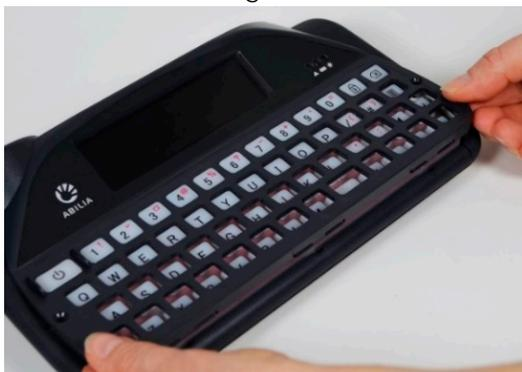
2. Nachdem Sie die Tastenführung entfernt haben, entnehmen Sie vorsichtig alle Tasten von der Gummimatte und legen Sie zusammen mit der Tastenführung in warmes Seifenwasser. Lassen Sie sie einige Minuten einweichen, damit sämtlicher Schmutz gelöst wird. Passen Sie auf, dass Sie keine Tasten verlieren.
