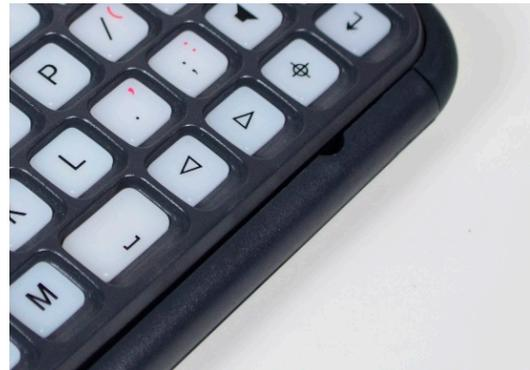
**Tipp** – Befindet sich an der Vorderseite der Tastenführung ein Spalt, müssen Sie diese herunterdrücken, bis Sie ordnungsgemäß einrastet.
